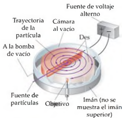
▲ Figura 21.6 Dibujo esquemático de un ciclotrón. Las partículas con carga se aceleran alrededor del anillo aplicando un voltaje alterno a los des.
